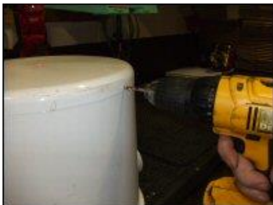
1. Borra ur nitarna som håller fast locket.
